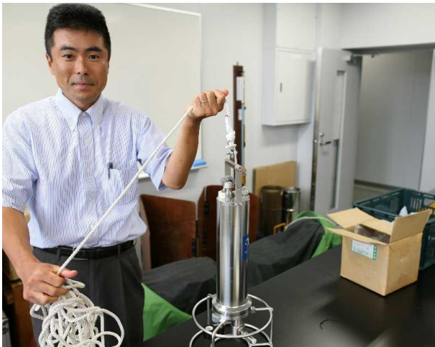
▲水中の塩分・水温・深さを測定する CTD 装置。橋から下して河口近くに進入する塩分を測定している。
